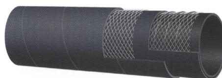
**STRUTTURA:** Sottostrato in gomma NR/SBR liscio nero anti-statico. Rinforzo con inserzioni tessili e spirali metalliche incorporate. Copertura in gomma NR/SBR liscia nera, antistatica ad impressione tela, resistente all'abrasione ed agli agenti atmosferici.
