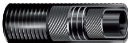
**STRUTTURA:** Sottostrato in gomma NR/SBR liscio nero anti-statico. Rinforzo con inserzioni tessili e spirale metallica incorporata. Copertura grecata in gomma NR/SBR liscia nera, antistatica ad impressione tela, resistente all'abrasione ed agli agenti atmosferici.
