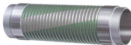
**STRUTTURA:** Spirale interna di acciaio galvanizzato, sottostrato in film di POLIESTERE, copertura in tessuto grigio rivestito di PVC, spirale esterna in acciaio galvanizzato.
