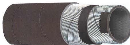
**STRUTTURA:** Sottostrato in gomma NBR liscio nero. Rinforzi tessili ad alta tenacità e cavetto di rame idoneo a garantire la continuità elettrica. Copertura in gomma NBR/PVC liscia nera antistatica ad impressione tela esterna, resistente agli oli, ai carburanti, agli agenti atmosferici.
