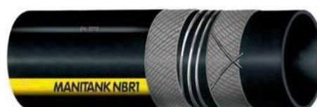
**STRUTTURA:** Sottostrato in gomma NBR1 antistatica ( $R < 10^6 \text{ Ohm/m.}$ ) liscio nero. Rinforzi tessili sintetici ad alta resistenza, spirale in acciaio incorporata, cavetti di rame inseriti per assicurare la dissipazione dell'elettricità statica. Copertura in gomma NBR nera, antistatica ( $R < 10^6 \text{ Ohm/m.}$ ) resistente all'abrasione, all'ozono, agli agenti atmosferici, ai grassi e agli oli minerali, liscia, impronta tela.
