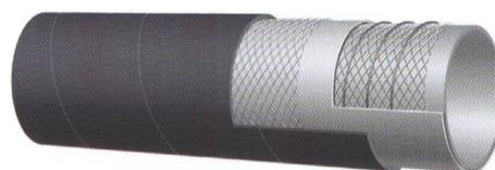
**STRUTTURA:** Sottostrato in gomma sintetica con resistenza condizionata agli oli, chiara, speculare, liscio. Conforme alla normativa F.D.A. e rispondente al D.M. 21.03.73 e successive modifiche. Rinforzi tessili sintetici e spirale in acciaio incorporata. Copertura in gomma sintetica nera, resistente all'abrasione ad agli agenti atmosferici, liscia ad impronta tela.
