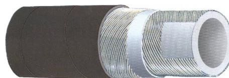
**STRUTTURA:** Sottostrato in gomma sintetica con resistenza condizionata agli oli, chiara, speculare, liscio. Conforme alla normativa F.D.A. e rispondente al D.M. 21.03.73 e successive modifiche. Rinforzi tessili sintetici. Copertura in gomma sintetica nera, resistente all'abrasione ed agli agenti atmosferici, liscia ad impronta tela.
