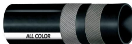
**STRUTTURA:** Sottostrato in UPE,(POLIETILENE AD ALTISSIMO PESO MOLECOLARE) neutro, liscio, con inserzioni tessili sintetiche, ad alta resistenza. Copertura in gomma EPDM nera, antistatica ( $R < 10^6$  Ohm), resistente all'abrasione, all'ozono e agli agenti atmosferici, liscia, impronta tela.
