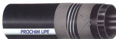
**STRUTTURA:** Sottostrato UPE (POLIETILENE AD ALTISSIMO PESO MOLECOLARE). Neutro, liscio. Rinforzo Inserzioni tessili sintetiche, ad alta resistenza. Spirale in acciaio incorporata. Cavetti di rame inseriti. Copertura in gomma EPDM nera, antistatica ( $R < 10^6$  Ohm), resistente all'abrasione, agli agenti atmosferici e all'invecchiamento, liscia, impronta tela.
