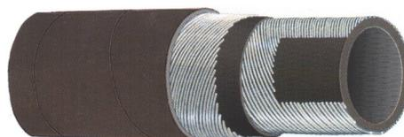
**STRUTTURA:** Sottostrato nero, liscio in gomma SBR. Rinforzo tessuti ad alta tenacità. Copertura nera, liscia, ad impressione tela in gomma SBR/EPDM, resistente all'abrasione ed agli agenti atmosferici.
