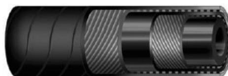
**STRUTTURA:** Sottostrato in gomma EPDM liscio nero con miscela resistente al vapore, con inserzioni di fili d'acciaio. Copertura microforata in gomma EPDM liscia nera ad impressione tela, resistente al calore, all'invecchiamento ed agli agenti atmosferici. Per una durata maggiore drenare dopo l'uso.
