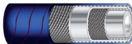
**STRUTTURA:** Sottostrato bianco liscio in gomma NBR di qualità alimentare inodore ed insapore confezionato su mandrini in acciaio INOX. Rinforzo tessuti sintetici ad alta tenacità. Copertura blu, liscia in gomma NBR ad impressione tela, resistente all'abrasione e all'ozono e agli agenti atmosferici.
