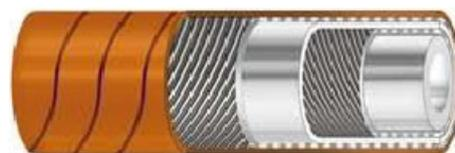
**STRUTTURA:** Sottostrato bianco liscio in gomma BIIR (Bromo-Butile) di qualità alimentare inodore ed insapore, confezionato su mandrini in acciaio INOX. Rinforzo tessuti sintetici ad alta tenacità. Copertura arancione, liscia in gomma EPDM ed impressione tela, resistente all'abrasione e all'ozono.
