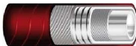
**STRUTTURA:** Sottostrato bianco liscio in gomma EPDM di qualità alimentare inodore ed insapore, confezionato su mandrini in acciaio INOX. Rinforzo tessuti sintetici ad alta tenacità e spirale metallica incorporata. Copertura rossa, liscia in gomma EPDM ad impressione tela, resistente all'abrasione e agli agenti atmosferici.
