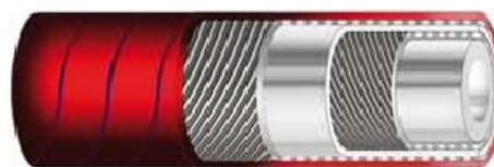
**STRUTTURA:** Sottostrato bianco liscio in gomma EPDM di qualità alimentare inodore ed insapore, confezionato su mandrini in acciaio INOX. Rinforzo tessuti sintetici ad alta tenacità. Copertura rossa, liscia in gomma EPDM ad impressione tela, resistente all'abrasione e agli agenti atmosferici.
