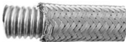
**DESCRIZIONE:** I tubi flessibili corrugati metallici sono la miglior soluzione al convogliamento di fluidi per alte e basse temperature e sono inoltre utilizzati per compensare disassamenti di montaggio. Si raccomanda l'utilizzo dei tubi per movimenti sullo stesso piano ed inoltre, per un corretto utilizzo, si consiglia di evitare torsioni in fase di montaggio, di non superare i raggi di curvatura indicati. Per ulteriori informazioni contattare n/s ufficio tecnico.
