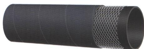
**STRUTTURA:** Sottostrato in gomma EPDM liscio nero, resistente al calore. Rinforzo con inserzioni tessili. Copertura esterna in gomma EPDM liscia nera ad impressione tela, resistente all'abrasione all'invecchiamento ed agli agenti atmosferici.
