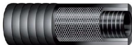
**STRUTTURA:** Sottostrato flessibile leggero in gomma SBR/NR liscia nera resistente all'abrasione. Rinforzo con inserzioni tessili e spirali metalliche incorporate. Copertura ondulata in gomma SBR/NR nera ad impressione tela, resistente all'abrasione e agli agenti atmosferici.
