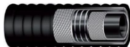
**STRUTTURA:** Sottostrato in gomma NR/SBR antistatico ( $R < 10^6$  Ohm/m) liscio nero, ottima resistenza all'abrasione. Rinforzo con tessuti sintetici ad alta tenacità, spirale in acciaio incorporata e treccia di rame per la messa a terra della tubazione. Copertura ondulata in gomma CR nera antistatica ( $R < 10^6$  Ohm/m) ad impressione tela esterna, resistente all'abrasione, all'ozono ed agli agenti atmosferici.
