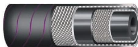
**STRUTTURA:** Sottostrato in gomma SBR liscio nero **durezza shore A85**. Rinforzo con inserzioni tessili. Copertura in gomma SBR/EPDM liscia nera, resistente all'abrasione ed agli agenti atmosferici.
