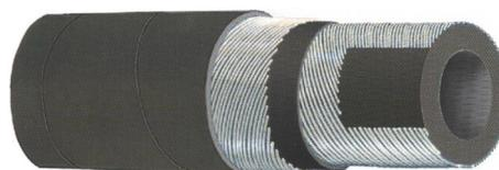
**STRUTTURA:** Sottostrato in gomma NR/SBR antistatico liscio nero. Rinforzo con inserzioni tessili. Copertura in gomma NR/SBR liscia nera antistatica ad impressione tela, resistente all'abrasione e agli agenti atmosferici.
