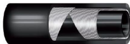
**STRUTTURA:** Sottostrato in gomma NBR liscio nero, rinforzo con tessuti ad alta tenacità. Copertura esterna in gomma NBR/PVC liscia nera, resistente agli oli e agli agenti atmosferici.
