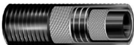
**STRUTTURA:** Sottostrato in gomma EPDM liscio nero resistente al calore. Rinforzo con inserzioni tessili e spirale metallica incorporata. Copertura in gomma EPDM grecata nera con scanalatura elicoidale, ad impressione tela, resistente all'abrasione ed agli agenti atmosferici.
