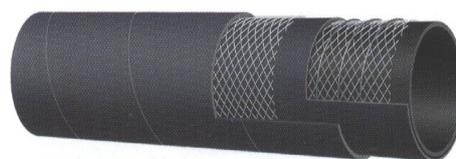
**STRUTTURA:** Sottostrato in gomma SBR liscio nero. Rinforzo con inserzioni tessili ad alta tenacità e spirale in acciaio incorporata. Copertura in gomma SBR / EPDM liscia nera ad impressione tela, resistente all'abrasione ed agli agenti atmosferici.
