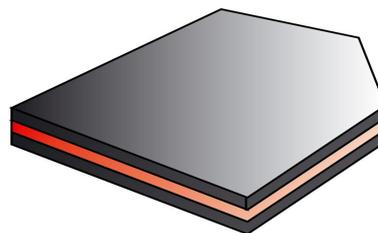
Qualità comunemente impiegata per la produzione di raschiatori per la pulizia dei nastri trasportatori. Durezza e rigidità sono caratteristiche base per la gomma sui due lati esterni, mentre all'interno viene inserita una gomma para di colore verde o colore rosso.
