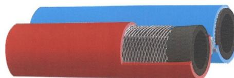
**STRUTTURA:** Sottostrato in gomma SBR liscio nero. Rinforzo con inserzioni tessili. Copertura in gomma SBR/EPDM liscia blu e rossa, resistente agli agenti atmosferici e all'invecchiamento.
