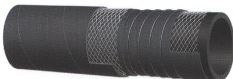
**STRUTTURA:** Sottostrato in gomma sintetica liscio nero. Rinforzo con inserzioni tessili ad alta tenacità, spirali in acciaio incorporate. Copertura in gomma sintetica liscia nera ad impressione tela, resistente agli oli e agli agenti atmosferici.
