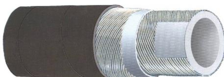
**STRUTTURA:** Sottostrato bianco, liscio in gomma EPR atossica. Rinforzo in tessuti sintetici ad alta tenacità. Copertura nera liscia in gomma EPDM ad impressione tela, resistente all'abrasione e agli agenti atmosferici.
