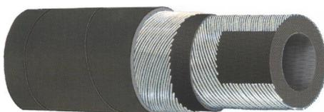
**STRUTTURA:** Sottostrato in gomma NR/SBR antistatica liscio nero. Rinforzo con inserzioni tessili. Copertura in gomma NR/SBR liscia nera antistatica ad impressione tela, resistente all'abrasione e agli agenti atmosferici.
