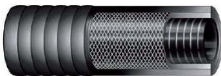
**STRUTTURA:** Tubo flessibile leggero con sottostrato in gomma SBR/NR liscia nera resistente all'abrasione, rinforzo con inserzioni tessili e spirale metallica incorporata. Copertura ondulata in gomma SBR/NR nera ad impressione tela, resistente all'abrasione e agli agenti atmosferici.
