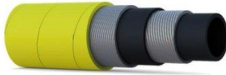
**STRUTTURA:** Sottostrato in gomma SBR liscio nero. Rinforzo con fili di acciaio ad alta resistenza. Copertura in gomma EPDM liscia gialla ad impressione tela, resistente all'abrasione ed agli agenti atmosferici.
