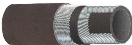
**STRUTTURA:** Sottostrato in gomma SBR liscio nero. Rinforzo con inserzioni tessili. Copertura in gomma SBR/EPDM liscia nera ad impressione tela, resistente all'abrasione ed agli agenti atmosferici.
