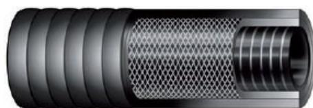
**STRUTTURA:** Sottostrato flessibile leggero in gomma SBR/NR liscia nera resistente all'abrasione. Rinforzo con inserzioni tessili e spirale metallica incorporata. Copertura ondulata in gomma SBR/NR nera ad impressione tela, resistente all'abrasione e agli agenti atmosferici.
