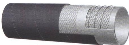
**STRUTTURA:** Sottostrato bianco, liscio in gomma EPR atossica. Rinforzo in tessuti sintetici ad alta tenacità e spirale metallica incorporata. Copertura nera liscia in gomma EPDM ad impressione tela, resistente all'abrasione e agli agenti atmosferici.
