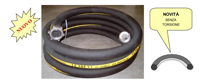
Tubo in gomma per pompe impastatrici di massetti, sottofondi e alleggeriti. Nr. 4 tele inserite. Pressione di lavoro 25 bar scoppio 75 bar.
