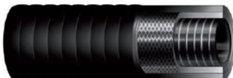
**STRUTTURA:** Sottostrato in gomma SBR/NR nera ondulato. Rinforzo con inserzioni tessili e spirali metalliche incorporate. Copertura in gomma SBR/NR nera ondulata ad impressione tela, resistente all'abrasione ed agli agenti atmosferici.
