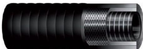
**STRUTTURA:** Sottostrato in gomma SBR/NR nera ondulato realizzato su profilo. Rinforzo con inserzioni tessili e spirali metalliche incorporate. Copertura in gomma SBR/NR nera ondulata ad impressione tela, resistente all'abrasione ed agli agenti atmosferici.
