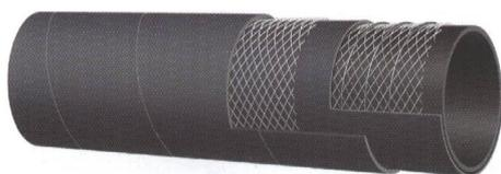
**STRUTTURA:** Sottostrato nero, liscio in gomma sintetica. Rinforzo con tessuti sintetici ad alta tenacità, e spirali in acciaio incorporate. Copertura nera liscia ad impressione tela, in gomma sintetica, resistente agli oli, all'ozono ed agli agenti atmosferici.
