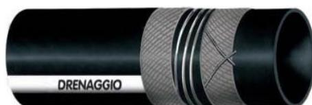
**STRUTTURA:** Sottostrato in gomma sintetica antiolio nero liscio. Rinforzi con inserzioni tessili sintetiche, ad alta resistenza. Spirale in acciaio incorporata. Cavetti di rame inseriti. Copertura in gomma sintetica nera, resistente agli idrocarburi con contenuto aromatico fino al 60%, liscia impronta tela.
