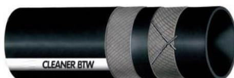
**STRUTTURA:** Sottostrato in gomma EPDM nero liscio. Rinforzi con inserzioni tessili sintetiche, ad alta resistenza. Cavetti di rame inseriti. Copertura in gomma base CR nera, resistente agli oli, all'ozono, agli agenti atmosferici, liscia impronta tela.
