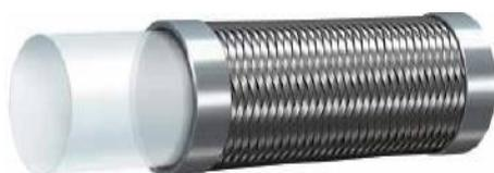
**STRUTTURA:** PTFE liscio, resistente alle sollecitazioni meccaniche, vibrazioni, bassa permeabilità, dielettrico, antifiamma, alimentare (approvato FDA, DVGW, BFR). Chimicamente inerte, antiaderente, resistente all'ozono ed all'invecchiamento atmosferico. Rinforzato trecce in acciaio inox ad alta tenacità AISI 304.
