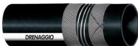
**STRUTTURA:** Sottostrato in gomma base CR nero liscio. Rinforzi con inserzioni tessili sintetiche, ad alta resistenza. Spirale in acciaio incorporata. Cavetti di rame inseriti. Copertura in gomma FPM nera, resistente agli idrocarburi con contenuto aromatico fino al 100%, liscia impronta tela.
