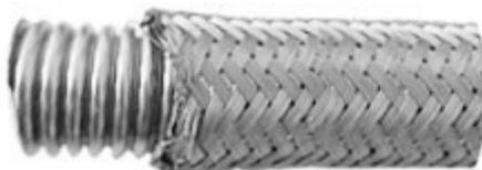
**DESCRIZIONE:** I tubi flessibili corrugati metallici sono la miglior soluzione al convogliamento di fluidi per alte e basse temperature e sono inoltre utilizzati per compensare disassamenti di montaggio. Si raccomanda l'utilizzo dei tubi per movimenti sullo stesso piano ed inoltre, per un corretto utilizzo, si consiglia di evitare torsioni in fase di montaggio, di non superare i raggi di curvatura indicati. Per ulteriori informazioni contattare n/s ufficio tecnico.
