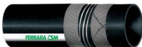
**STRUTTURA:** Sottostrato CSM (HYPALON POLIETILENE CLO-ROSOLFATO) Nero, liscio. Rinforzo inserzioni tessili sintetiche, ad alta resistenza. Spirale in acciaio incorporata. Cavetti di rame inseriti. Copertura in gomma CR nera, antistatica ( $R < 10^6$  Ohm), resistente all'abrasione e agli agenti atmosferici, liscia, impronta tela.
