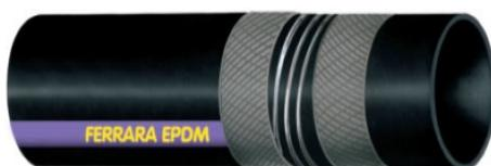
**STRUTTURA:** Sottostrato gomma EPDM, (TERPOLIMERO ETILENE PROPILENEDIENE) antistatica ( $R < 10^6 \Omega$ ). Nero, liscio. Rinforzo con inserzioni tessili sintetiche, ad alta resistenza, spirale in acciaio incorporata, su richiesta, cavetti di rame inseriti. Copertura in gomma EPDM nera antistatica ( $R < 10^6 \Omega$ ) resistente all'abrasione, all'ozono e agli agenti atmosferici, liscia, impronta tela.
