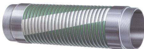
**STRUTTURA:** Spirale interna di acciaio inossidabile in polipropilene, sottostrato film di polipropilene, copertura tessuto grigio rivestito di PVC, spirale esterna in acciaio inossidabile
