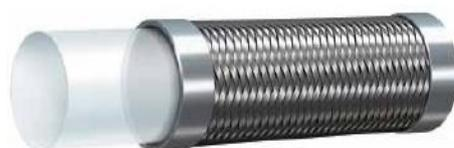
**STRUTTURA:** PTFE liscio, resistente alle sollecitazioni meccaniche, vibrazioni, bassa permeabilità, dielettrico, antifiama, alimentare (approvazione FDA, DVGW, BFR). Chimicamente inerte, antiaderente, resistente all'ozono ed all'invecchiamento atmosferico. Rinforzato trecce in acciaio inox ad alta tenacità AISI 304.
