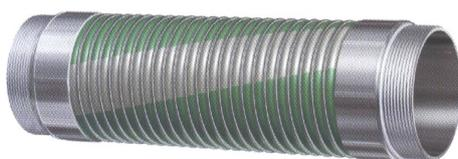
**STRUTTURA:** Spirale interna di acciaio galvanizzato, sottostato in film di POLIESTERE, copertura in tessuto grigio rivestito di PVC, spirale esterna in acciaio galvanizzato.
