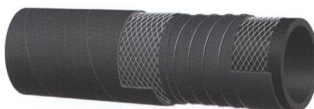
**STRUTTURA:** Sottostrato in gomma sintetica liscio nero. Rinforzo con inserzioni tessili ad alta tenacità, spirali in acciaio incorporate. Copertura in gomma sintetica liscia nera ad impressione tela, resistente agli oli e agli agenti atmosferici.
