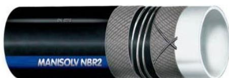
**STRUTTURA:** Sottostrato in gomma chiara, liscio. Rinforzi tessili sintetici ad alta resistenza, spirale in acciaio incorporata, cavetti di rame inseriti per assicurare la dissipazione dell'elettricità statica. Copertura in gomma NBR nera, anti-statica ( $R < 10^6 \text{ Ohm/m.}$ ) resistente all'abrasione, all'ozono, agli agenti atmosferici, ai grassi e agli oli minerali, liscia, impronta tela.
