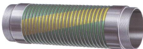
**STRUTTURA:** Spirale interna di acciaio galvanizzato, sottostato in film di POLIPROPILENE, copertura in tessuto grigio rivestito di PVC, spirale esterna in acciaio galvanizzato.
