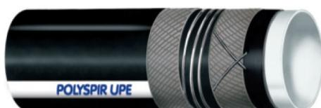
**STRUTTURA:** Sottostrato UPE (POLIETILENE AD ALTISSIMO PESO MOLECOLARE), chiaro, liscio, speculare. **Omologato BgVV, rispondente al FDA e al D.M. 21.03.73 e successive modifiche.** RINFORZI: Inserzioni tessili sintetiche, ad alta resistenza. Spirale in acciaio incorporata. Cavetti di rame inseriti. Copertura in gomma EPDM nera, antistatica ( $R < 10^6$  Ohm), resistente all'abrasione, all'ozono e agli agenti atmosferici, liscia, impronta tela.
