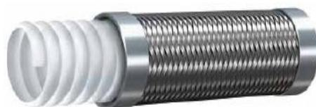
**STRUTTURA:** PTFE corrugato, resistente alle sollecitazioni meccaniche, vibrazioni, bassa permeabilità, dielettrico, antifiama, alimentare (approvato FDA, DVGW, BFR). Chimicamente inerte, antiaderente, resistente all'ozono ed all'invecchiamento atmosferico. Rinforzato trecce in acciaio inox ad alta tenacità AISI 304.
