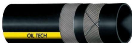
**STRUTTURA:** Sottostrato in gomma NBR, antistatica ( $R < 10^6 \text{ Ohm}$ ) nero liscio. Rinforzi con inserzioni tessili sintetiche, ad alta resistenza. Spirale in acciaio incorporata. Cavetti di rame inseriti. Copertura in gomma CR nera antistatica ( $R < 10^6 \text{ Ohm}$ ) autoestinguente, resistente all'abrasione, all'ozono, all'acqua di mare, agli agenti atmosferici e al contatto con grassi e oli minerali, liscia impronta tela. Autoestinguente secondo la normativa ASTM C 542.
