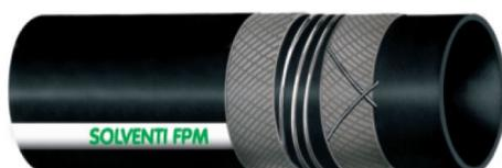
**STRUTTURA:** Sottostrato in FPM—FKM (VITON ESAFLUORO PROPILENE VINILIDENE FLUORIDE). Neutro, liscio. Rinforzo inserzioni tessili sintetiche, ad alta resistenza. Spirale in acciaio incorporata. Cavetti di rame inseriti. Copertura in gomma CR nera, antistatica ( $R < 10^6$  Ohm), resistente all'abrasione, agli agenti atmosferici, all'ozono e all'invecchiamento, liscia, impronta tela.
