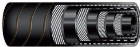
**STRUTTURA:** Sottostrato in gomma NR/SBR antistatico liscio nero. Rinforzo con 4 tessuti sintetici divisi ad alta resistenza. Copertura in gomma NR/SBR liscia nera antistatica ad impressione tela, resistente all'abrasione e agli agenti atmosferici.
