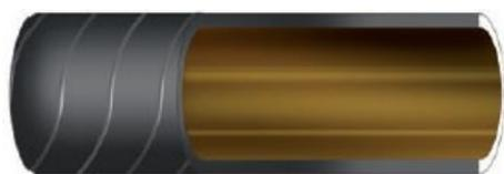
**STRUTTURA:** Sottostrato in sola gomma para naturale NR marrone liscia, durezza shore A 45. Copertura in gomma NR nera liscia ad impressione tela, durezza shore A45, resistente all'ozono e all'abrasione.
