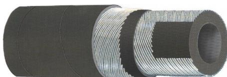
**STRUTTURA:** Sottostrato in gomma NR/SBR antistatico liscio nero. Rinforzo con inserzioni tessili. Copertura in gomma NR/SBR liscia nera antistatica ad impressione tela, resistente all'abrasione e agli agenti atmosferici.
