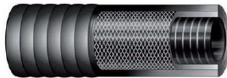
**STRUTTURA:** Tubo flessibile molto sottile e leggero con sottostrato in gomma SBR/NR liscia nera resistente all'abrasione, rinforzo con inserzioni tessili e spirale metallica incorporata. Copertura ondulata in gomma SBR/NR nera ad impressione tela, resistente all'abrasione e agli agenti atmosferici.
