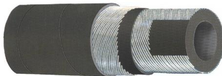
**STRUTTURA:** Sottostrato in gomma NR/SBR antistatico liscio nero. Rinforzo con tessuti sintetici ad alta resistenza. Copertura in gomma NR/SBR liscia nera antistatica ad impressione tela, resistente all'abrasione e agli agenti atmosferici.
