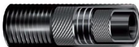
**STRUTTURA:** Sottostrato in gomma NR/SBR liscio nero anti-statico. Rinforzo con inserzioni tessili e spirale metallica incorporata. Copertura grecata in gomma NR/SBR liscia nera, antistatica ad impressione tela, resistente all'abrasione ed agli agenti atmosferici.
