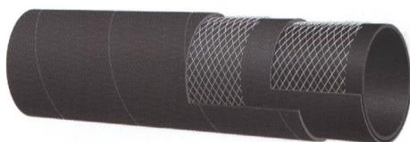
**STRUTTURA:** Sottostrato in gomma NR/SBR antistatico liscio nero. Rinforzo con inserzioni tessili. Copertura in gomma NR/SBR liscia nera, antistatica ad impressione tela, resistente all'abrasione ed agli agenti atmosferici.
