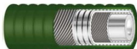
**STRUTTURA:** Sottostrato traslucido chiaro, in UHMWPE (polietilene ad alto peso molecolare) alimentare, inodore e insapore, confezionato su mandrini in acciaio INOX. Rinforzo tessuti sintetici ad alta tenacità e doppia spirale metallica incorporata. Copertura verde, semiondulata in gomma EPDM ad impressione tela, resistente all'abrasione e agli agenti atmosferici.
