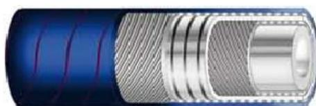
**STRUTTURA :** Sottostrato bianco, liscio in gomma EPDM di qualità alimentare, inodore ed insapore. Rinforzo con inserzioni tessili ad alta tenacità e spirale metallica incorporata. Copertura in gomma EPDM blu ad impressione tela, resistente ad abrasione, ozono ed agenti atmosferici
