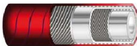
**STRUTTURA:** Sottostrato bianco liscio in gomma EPDM di qualità alimentare inodore ed insapore, confezionato su mandrini in acciaio INOX. Rinforzo tessuti sintetici ad alta tenacità. Copertura rossa, liscia in gomma EPDM ad impressione tela, resistente all'abrasione e agli agenti atmosferici.
