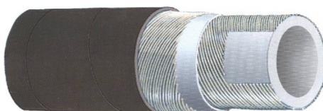
**STRUTTURA:** Sottostrato in gomma sintetica con resistenza condizionata agli oli, chiara, speculare, liscio. Conforme alla normativa F.D.A. e rispondente al D.M. 21-03.73 e successive modifiche. Rinforzi tessili sintetici. Copertura in gomma sintetica nera, resistente all'abrasione ad agli agenti atmosferici, liscia ad impronta tela.
