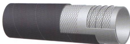
**STRUTTURA:** Sottostrato in gomma base NR, chiara, antiabrasiva, atossica, speculare, liscio. Conforme alla normativa FDA, alle raccomandazioni BgVV e al D.M. 21.03.73 e successive modifiche. Rinforzi tessili sintetici e spirale in acciaio incorporata, cavetto rame inserito. Copertura gomma sintetica, nera, antiabrasiva e antistatica ( $R < 1 \text{ Mohm}$ ), resistente agli agenti atmosferici, liscia, impronte tela.
