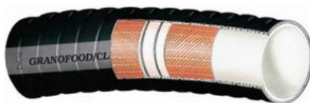
**STRUTTURA:** Sottostrato in poliuretano (PU) atossico, chiaro, speculare, liscio. Conforme alla normativa FDA, alle raccomandazioni BgVV e al D.M. 21.03.73 e successive modifiche. Rinforzi tessili sintetici e spirali in acciaio incorporate. Cavetti di rame inseriti. Copertura in gomma sintetica, nera, antiabrasiva, antistatica ( $R < 1 \text{ Mohm}$ ), ad ampia ondulazione, impronta tela.
