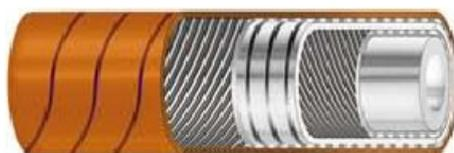
**STRUTTURA:** Sottostrato bianco liscio in gomma BIIR (Bromo-Butile) di qualità alimentare inodore ed insapore, confezionato su mandrini in acciaio INOX. Rinforzo tessuti sintetici ad alta tenacità e spirale metallica incorporata. Copertura arancione, liscia in gomma EPDM ed impressione tela, resistente all'abrasione e all'ozono.
