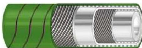
**STRUTTURA:** Sottostrato traslucido chiaro in UHMWPE (polietilene ad alto peso molecolare) alimentare inodore ed insapore confezionato su mandrini in acciaio INOX. Rinforzo tessuti sintetici ad alta tenacità. Copertura verde liscia in gomma EPDM ad impressione tela, resistente alla abrasione e agli agenti atmosferici.
