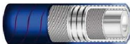
**STRUTTURA:** Sottostrato bianco liscio in gomma NBR di qualità alimentare inodore ed insapore confezionato su mandrini in acciaio INOX. Rinforzo tessuti sintetici ad alta tenacità e spirale metallica incorporata. Copertura blu, liscia in gomma NBR ad impressione tela, resistente all'abrasione e all'ozono.
