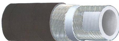
**STRUTTURA:** sottostrato in gomma base NR, chiara, antiabrasiva, atossica, speculare, liscio. Conforme alla normativa FDA, alle raccomandazioni BgVV e a al D.M. 21.03.73 e successive modifiche. Rinforzi tessili sintetici, cavetto rame inserito. Copertura in gomma sintetica, nera, antiabrasiva e anti-statica ( $R < 1 \text{ Ohm/m}$ ) resistente agli agenti atmosferici, liscia impronte tela.
