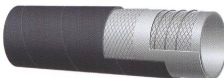
**STRUTTURA:** Sottostrato in gomma sintetica con resistenza condizionata agli oli, chiara, speculare, liscio. Conforme alla normativa F.D.A. e rispondente al D.M. 21-03.73 e successive modifiche. Rinforzi tessili sintetici e spirale in acciaio incorporata. Copertura in gomma sintetica nera, resistente all'abrasione, all'ozono e all'invecchiamento, lascia ad impronta tela.
