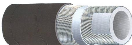
**STRUTTURA:** Sottostrato bianco, liscio in gomma NR di qualità alimentare inodore ed insapore confezionato su mandrini in acciaio INOX. Rinforzo in tessuti sintetici ad alta tenacità e cavetto di rame incorporato per la messa a terra della tubazione. Copertura nera liscia in gomma NR/SBR antistatica ( $R < 10^6 \text{ Ohm/m}$ ) ad impressione tela, resistente all'abrasione e agli agenti atmosferici.
