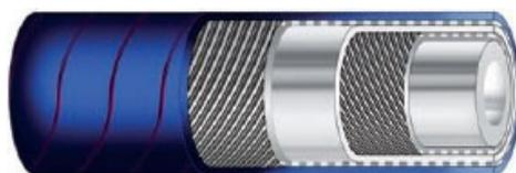
**STRUTTURA:** Sottostrato bianco, liscio in gomma EPDM di qualità alimentare. Rinforzo con tessuti ad alta tenacità. Copertura blu, liscia ad impressione tela in gomma EPDM, resistente all'abrasione all'ozono e agli agenti atmosferici. **Per una durata maggiore drenare dopo l'uso.**
